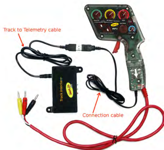
Figura 30: conexión de la Track Interface al mando SCP-01.
