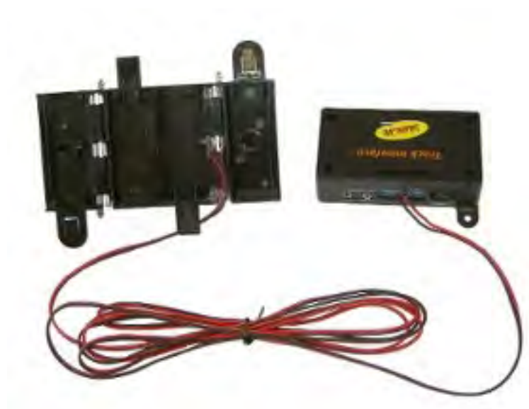
Figura 29: ejemplo de conexión de un corte de pista a la Track Interface.
