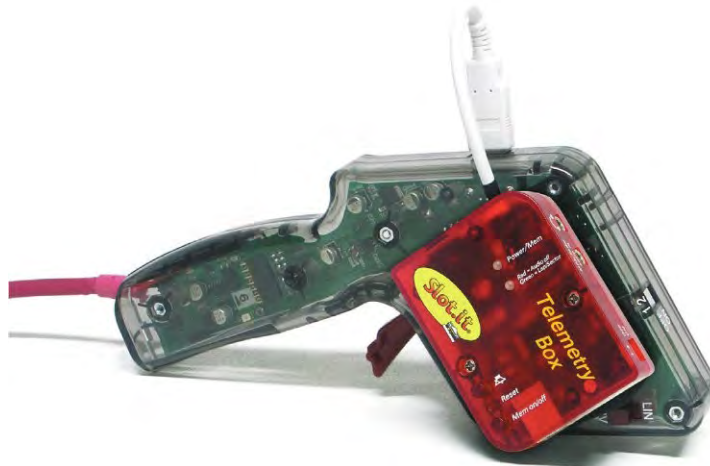
Figura 11: Universal Live Timing Box montada en el mando SCP.
